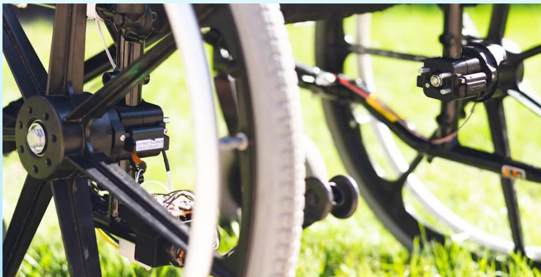
Rys. 7. Urządzenie zapobiegające cofaniu z czujnikiem nachylenia do ręcznych wózków inwalidzkich
